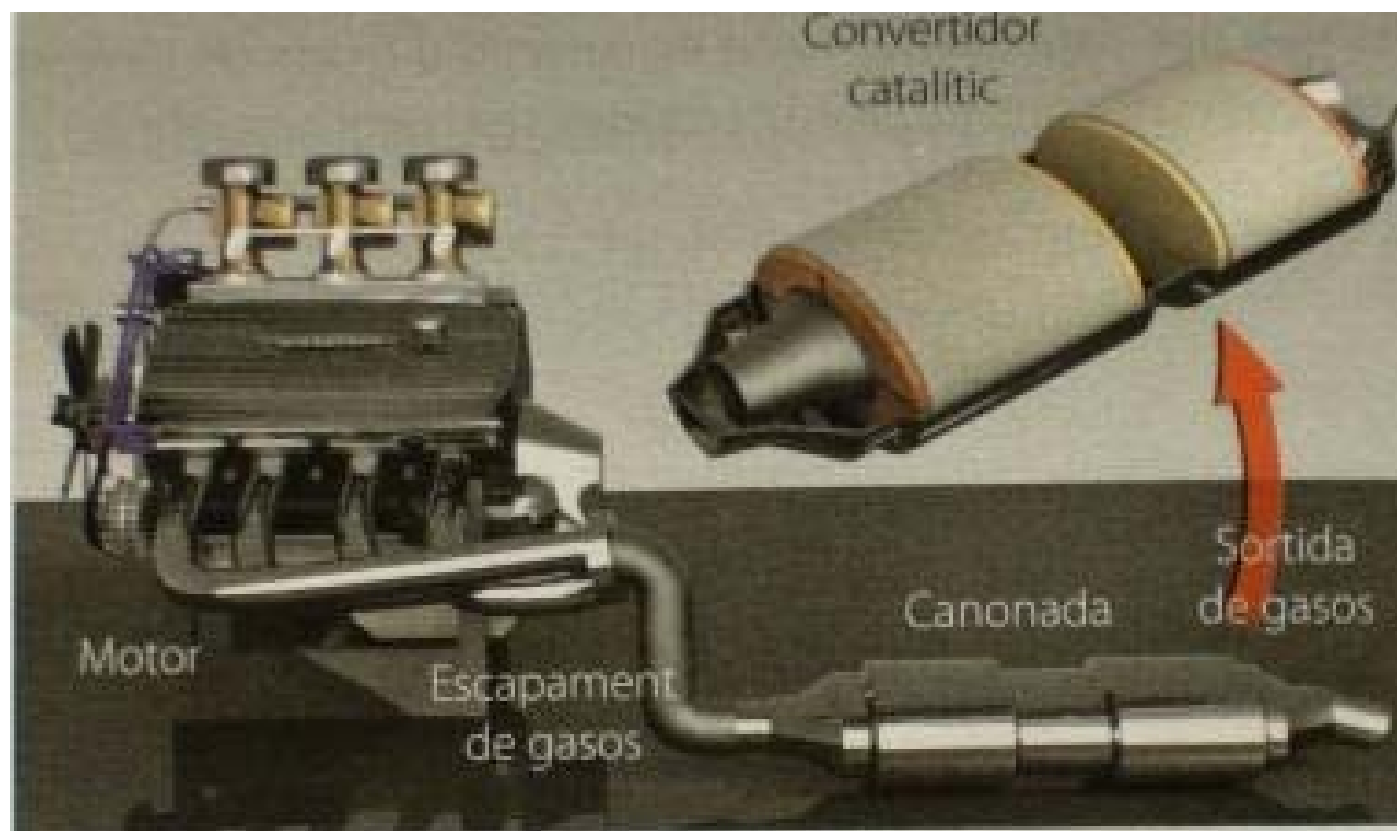
Figura 6.19. En el tub d'escapament dels cotxes, s'hi col·loca un catalitzador que afavoreix la reacció dels òxids de nitrogen convertint-los en gasos no contaminants:
